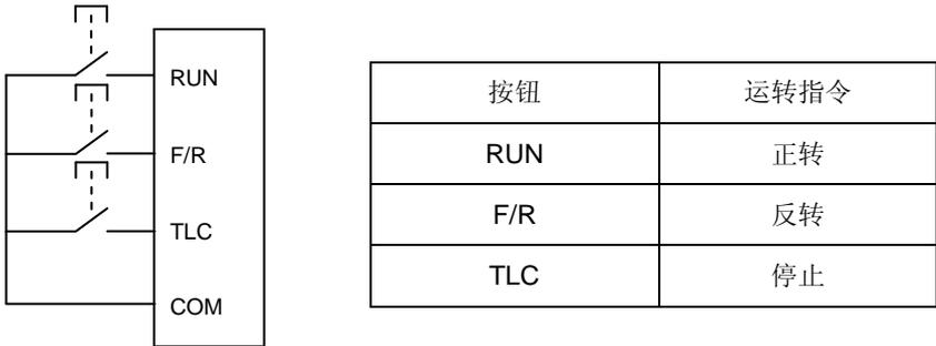
图 6-6 外控端子控制运行方式示意图
