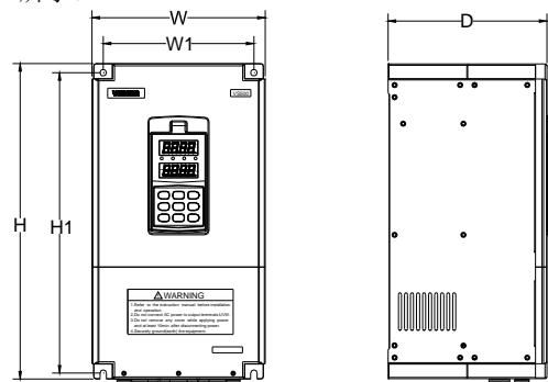
图 2-4-B 变频器的安装尺寸
