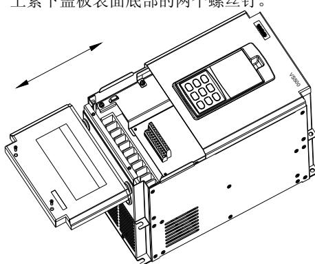
图 2-3-B 盖型盖板的拆卸与安装
