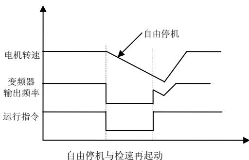
图 6-17 启动与停机频率输出曲线
