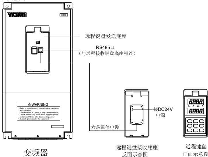
图 B-5 远程键盘连接示意图
