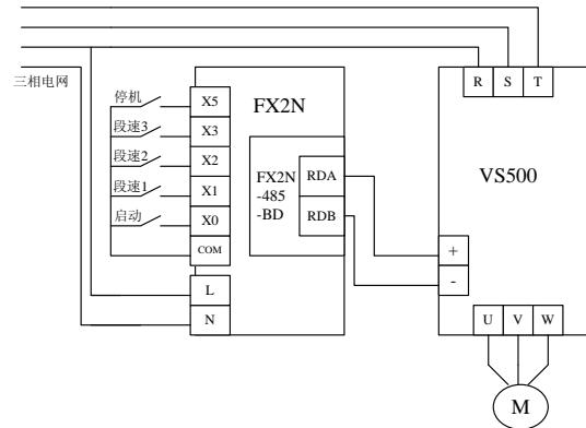
图 2 主回路接线图
