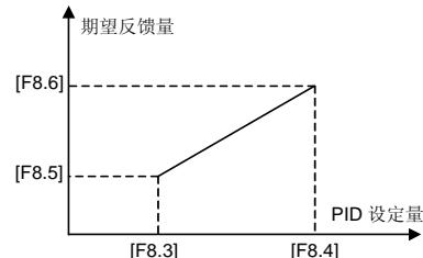
图 6-31 PID 给定量与反馈量的关系
