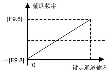
图 6-34 辅助频率的调整幅度
