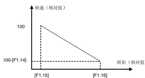
图 6-9 下垂控制作用时的电机特性
