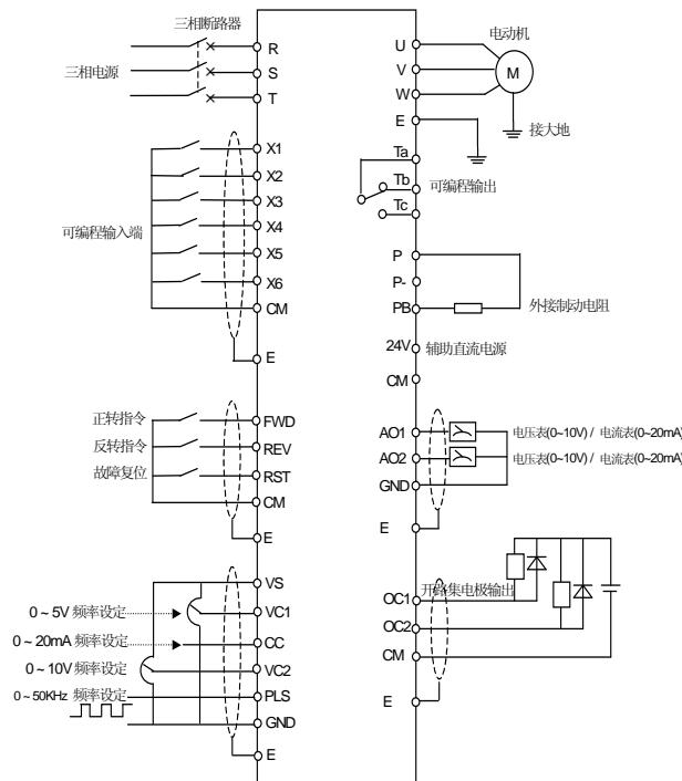
图 3-3 VS500 系列变频器基本接线图
