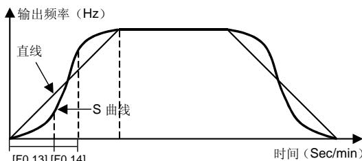
图 6-3 加减速曲线
