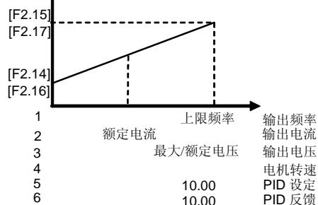
图 6-11 模拟输出端子的模拟输出内容
