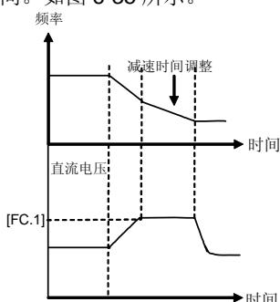
图 6-35 减速中的电压失速保护
