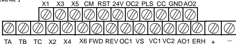
图 3-4 控制回路端子示意图
