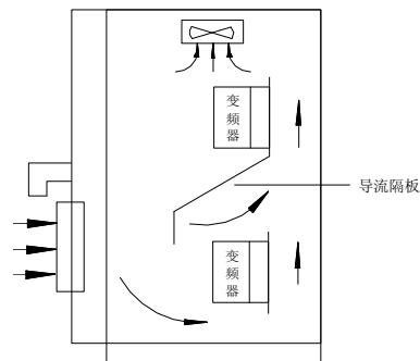
图 2-1-B 多台变频器的安装
