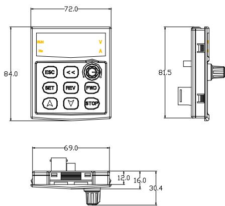
图 B-3 小操作面板安装底座的尺寸
