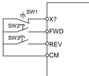
图 6-1 三线控制模式接线图
