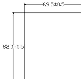
图 B-4 小操作面板底座安装开孔尺寸
