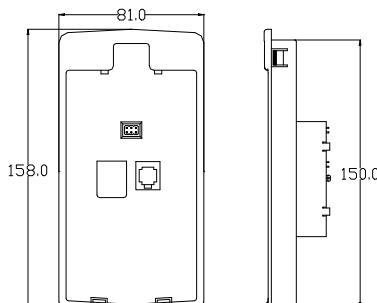
图 B-1 操作面板安装底座的尺寸
