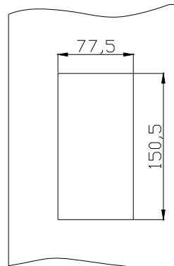
图 B-9 安装尺寸: 150.5×77.5mm
