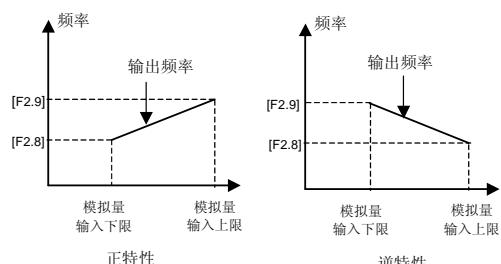
图 6-10 模拟输入与设定频率对应图示
