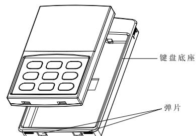
图 2-2 操作面板的拆卸和安装
